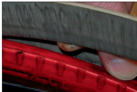
Entwicklungsphase: Dank PEEK bereits unbeschädigte Führungsbänder, noch ohne Nutzung
