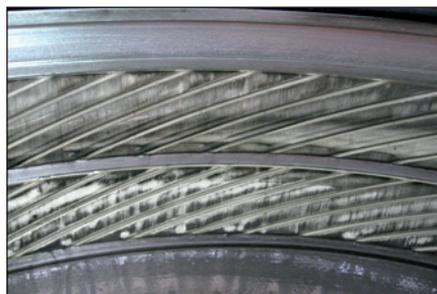
Endversion: PEEK-Band mit diagonalem Nutmuster, unbeschädigt trotz härtestem Dauereinsatz
